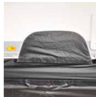
Tochtstrook met klittenband incl. optionele ronde wielkastafdekking
