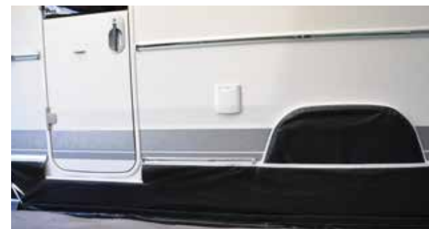
Aangepaste tochtstrook met ronde wielkastafdekking
